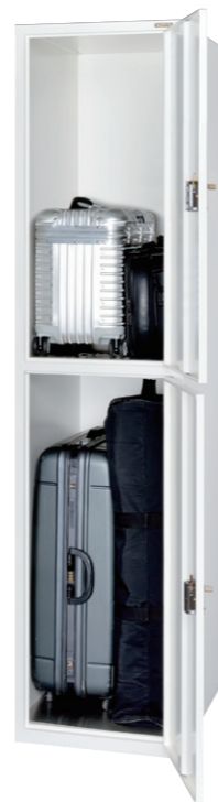
● ESUK1-2 / スーツケースロッカー (1列2段2口用) H2000×W462.5×D700 (h953.5×w412.5) 横中仕切板溶接固定、扉(補強付)、コインリターン錠、ステンレス床板付 ※ボンデ鋼板仕様
