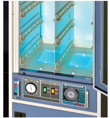
■ 横仕切上の酸化チタンコーティング光触媒パネル
