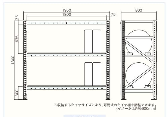
※収納するタイヤサイズにより、可動式のタイヤ棚を調整できます。
