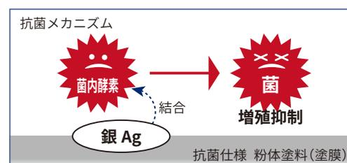
塗膜中の銀が手に付着している大腸菌などの菌内の酵素（たんぱく質）と結合し、代謝機能を抑え、菌の増殖を抑制します。
