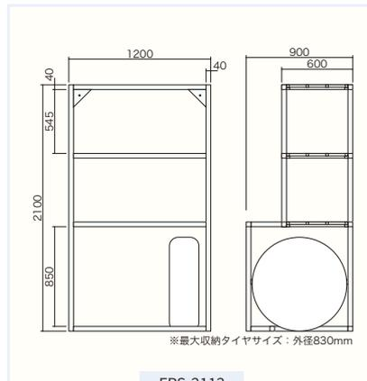
※最大収納タイヤサイズ：外径830mm
