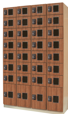
YMRZ4-8 (4列8段 32人用) H1800×W1100×D350 上段：扉寸h187.22×w267 最下段：扉寸h379.46×w267 扉：ポリカーボネート窓付、木目シート貼仕上 ※スライドヒンジ仕様
