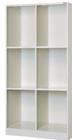
TF2-3N (2列3段 6人用) H1790×W900×D510 横中仕切板差込構造(補強付)、底板(補強付)、各部溶接補強、巾木一体、名札差プレス加工
