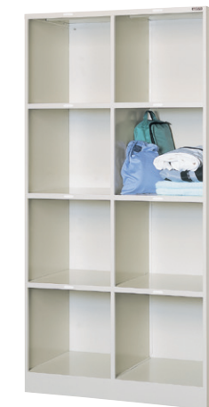
TF2-4N (2列4段 8人用) H1790×W900×D510 横中仕切板差込構造(補強付)、底板(補強付)、各部溶接補強、巾木一体、名札差プレス加工
