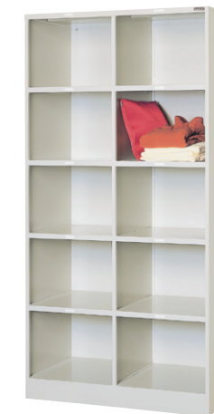
TF2-5N (2列5段 10人用) H1790×W900×D510 横中仕切板差込構造(補強付)、底板(補強付)、各部溶接補強、巾木一体、名札差プレス加工
