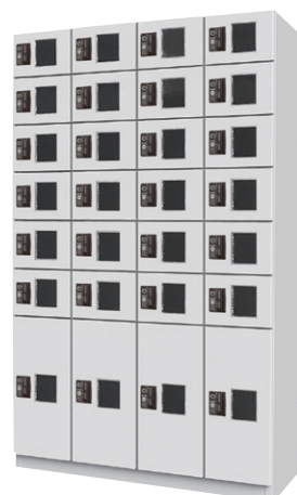
YCRY4-7 (4列7段 28人用) H1800×W1100×D350 上段：扉寸h187.22×w267 最下段：扉寸h571.68×w267 扉：ポリカーボネート窓付、塗装仕上 ※スライドヒンジ仕様
